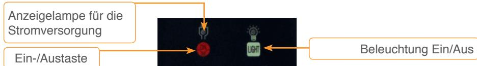
Vor Beginn des Betriebs müssen Sie den Ein-/Ausschalter betätigen. Nun leuchtet die Anzeigelampe für die Stromversorgung. Drücken Sie nach Betriebsende diese Taste erneut, die Anzeigelampe erlischt.
