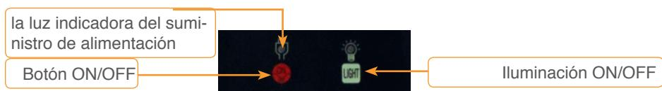
Antes de iniciar el funcionamiento, debe pulsar el interruptor de encendido / apagado. Ahora se encenderá la luz indicadora del suministro de alimentación. Tras finalizar el funcionamiento, debe volver a pulsar este botón y se apagará la luz indicadora.
