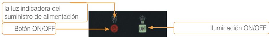
Antes de iniciar el funcionamiento, debe pulsar el interruptor de encendido / apagado. Ahora se encenderá la luz indicadora del suministro de alimentación. Tras finalizar el funcionamiento, debe volver a pulsar este botón y se apagará la luz indicadora.
