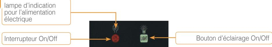
Pour démarrer, il faut pousser le bouton on/off. La lampe d'indication pour l'alimentation électrique s'illuminera. Après l'utilisation, on doit mettre le four hors service en poussant ce bouton de nouveau. La lampe d'indication s'éteindra.
