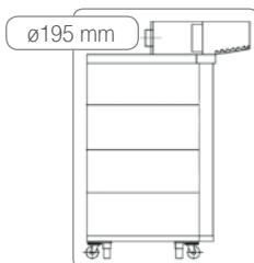
Se recomienda montar una campana con un extractor directamente encima del horno para liberar el vapor y el humo de cocción de la sala. Es necesario contar con un fuelle metálico con Ø200 para conectar la campana con la abertura en la pared o el techo, de este modo puede reducirse al máximo el riesgo de corrosión y cortocircuito ocasionado por la humedad.
